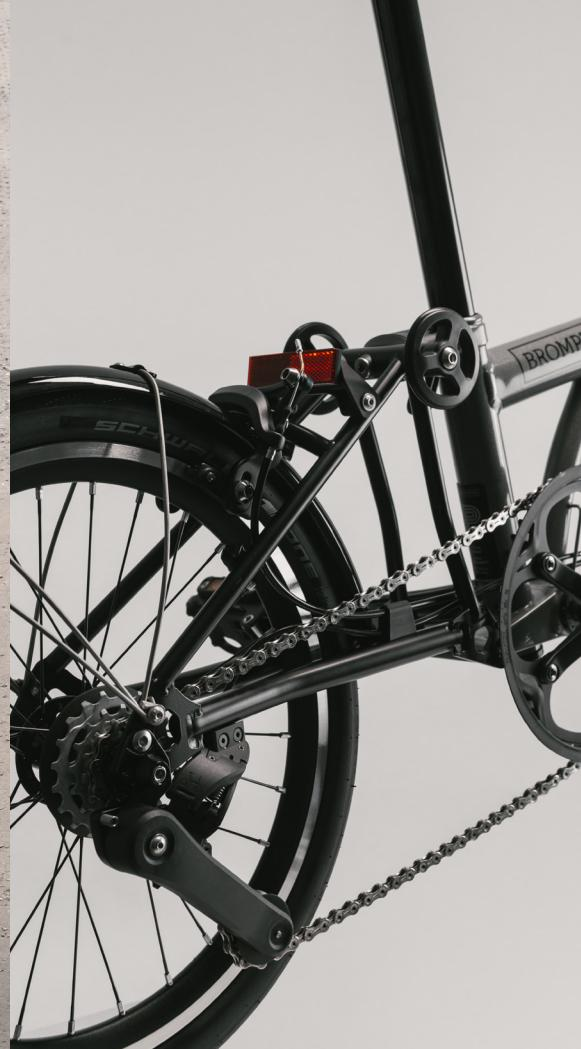
Das kompakte 4-Gang-System mit einem brandneuen 60-Gramm-Umwerfer ist präzise entwickelt, damit es in das eng gefaltete Rad passt.
